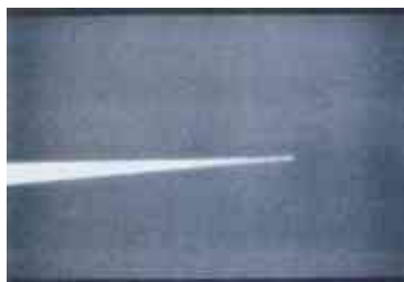
شکل ۳ - تصویر یک نانوفیبر تولید شده به شیوه کشش لیزری
