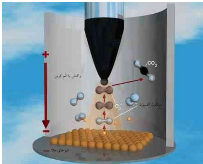
نانوحسگر گازی - این تصویر، سازوکار اندازه گیری گاز CO2 را نشان می دهد
